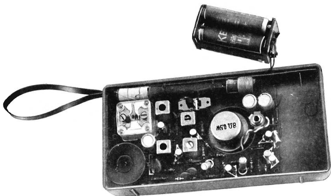
Fig. 5 - Ai lettori principianti raccomandiamo di non commettere errori di polarità all'atto dell'inserimento delle pile nel contenitore. Lungo l'asse centrale del contenitore sono riportati i segni che caratterizzano le tensioni positive e quelle negative; in ogni caso occorre tener presente che il polo negativo della pila deve formare contatto con la lamella flessibile, mentre il polo positivo deve formare contatto elettrico con la lamella rigida.
